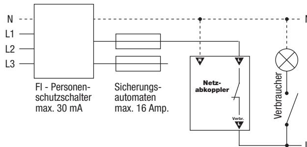
Vor dem Einbau Vorsicherung ausschalten. Eingang "N" mit der Neutralleiterstiecke und Eingang "L" mit dem Ausgang des relevanten Sicherungsautomaten verbinden. Vorsicherung einschalten.
